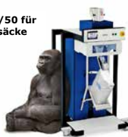
WBE 25/50 S mit Handnähmaschine für Offensäcke
